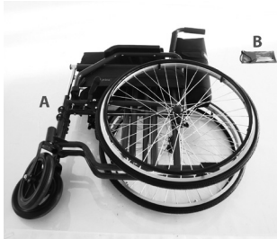
A - Cadre de base du fauteuil roulant B - Jeu de clés pour l'assemblage
